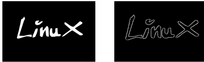
Рисунок 1. – Изображения: a – объект, декомпозиция которого на множество замкнутых контуров возможна, n = 3 ; b – декомпозиционное множество замкнутых контуров объекта изображения, смотри рисунок 1, a ); в – изображение; г – бинарное изображение, смотри рисунок 1, в ) (все объекты простые)
