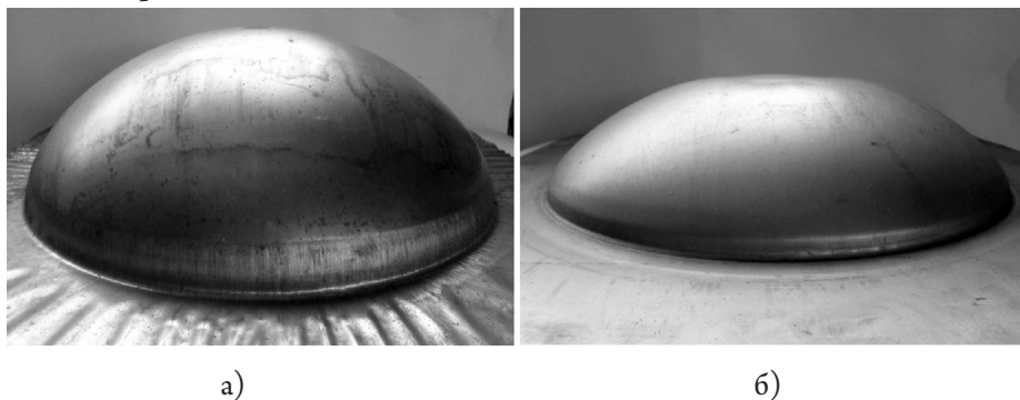
Рис. 4. Детали типа днищ: а) — полусфера; б) — полусфера с плоским дном
